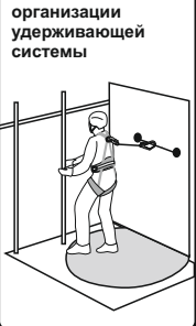
Рис. 12. Способ организации удерживающей системы
